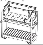
Fig 1 : Coloque los laterales sobre la base y fije los bulones , con sus arandelas correspondientes, a las tuercas remachadas ubicadas en los extremos de la base.
