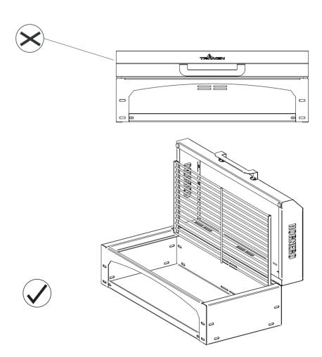
La zona de la tapa es propensa al deterioro prematuro de la pintura por acción de la llama en contacto directo con el recubrimiento.
